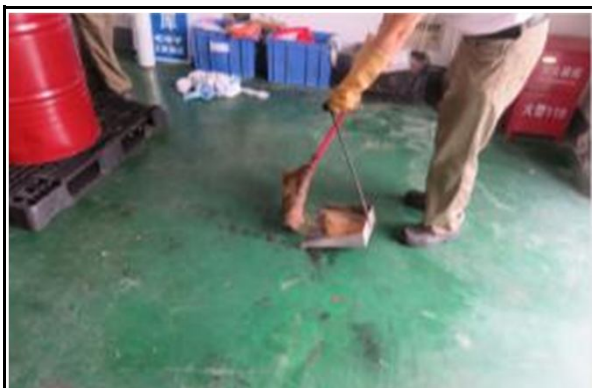
清扫吸附废矿物油的木屑
