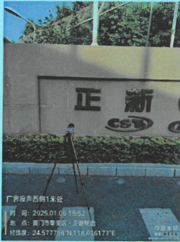
厂界噪声西侧 1 米处 (昼间)
