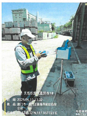
危废房(外)无组织废气监测点 1#
